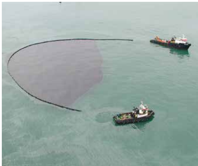
▲ Рис. 8: Надувной бон, развернутый по U-образной конфигурации между двумя судами для сдерживания тяжелой нефти. Заключительным этапом успешной операции будет сбор нефти.
