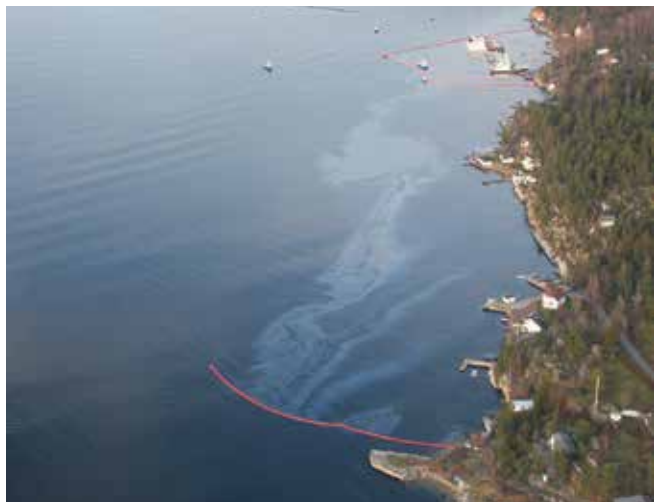
▲ Рис. 14: Бон, используемый как ветка для перенаправления нефти к берегу для сбора (© Norwegian Coastal Administration).
