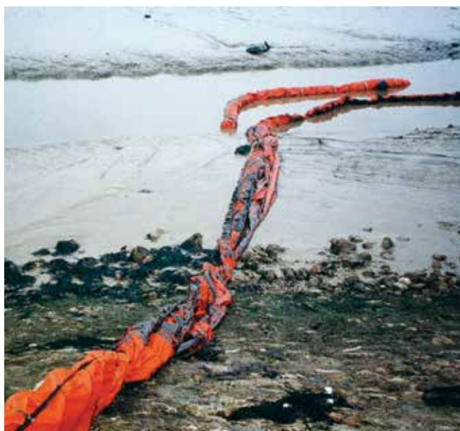
▲ Рис. 5: Бон может быть легко поврежден после развертывания. Необходимо постоянное наблюдение для поддержания эффективности бона на протяжении всего приливо-отливного цикла.
