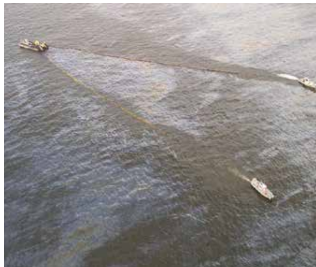
▲ Рис. 9: Бон-занавес, развернутый по V-образной конфигурации двумя буксирными судами, с отдельным нефтесобирающим судном в центре.
