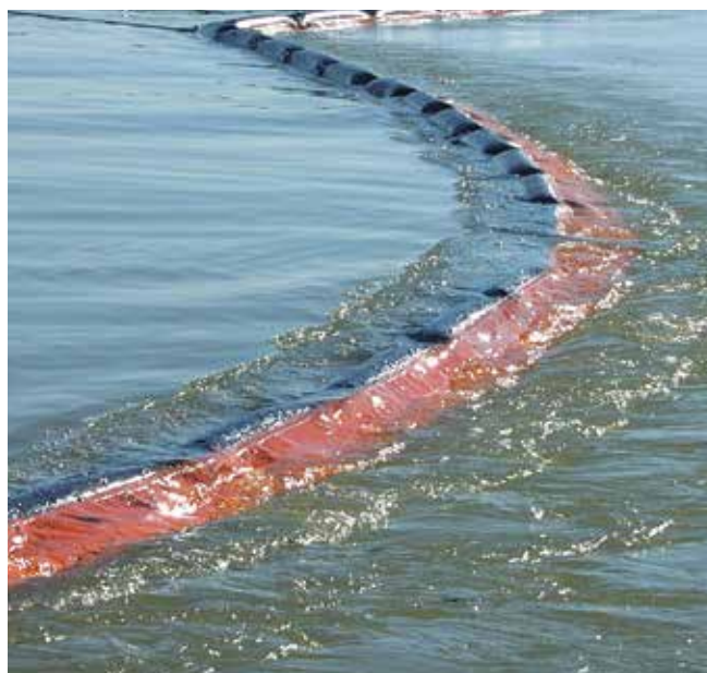
▲ Рис. 4: Сильное течение вызвало глиссирование бона, что привело к протеканию нефти под юбкой.
