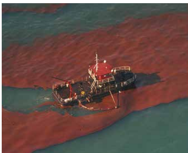
▲ Рис. 10: Одно судовая система сбора, применяющая короткий бон-занавес, разворачиваемый с катамарана для сбора нефти в сильно эмульгированном пятне.
