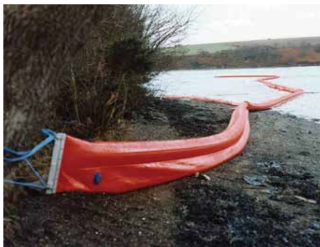
▲ Рис. 18: Бон для экранирования береговой линии, развертываемый в устье реки. Балластные камеры низкого уровня воды позволяют дну сесть на берег при самом низком уровне отлива. В этом примере бон для экранирования береговой линии соединен с секциями надувного бона-занавеса.
