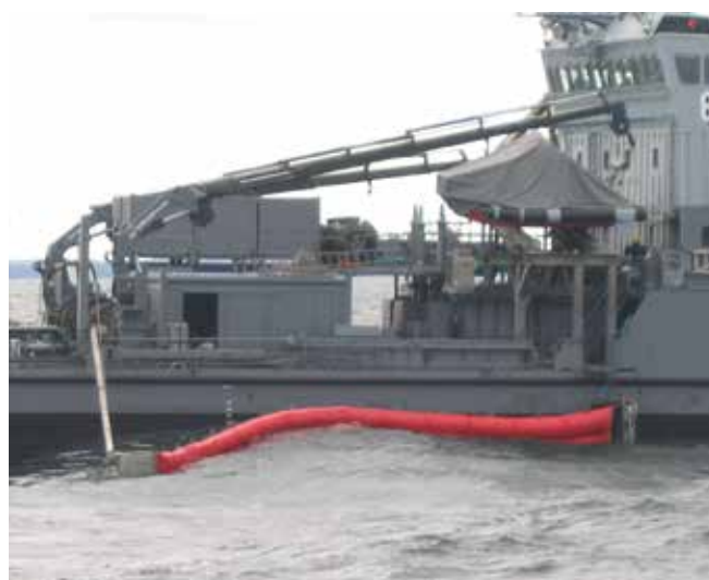
▲ Рис. 11: Достаточно гибкий для следования движению волн, бон поднялся из воды, где он прикрепляется к корпусу судна, что может привести к протеканию нефти.
