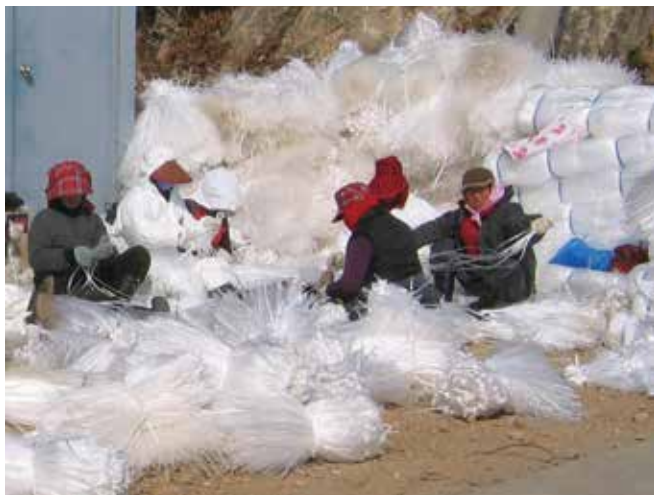
▲ Рис. 6: Жители местных деревень изготавливают ловушки из лент полипропилена. Изготовление сорбентов из местных доступных материалов может быть экономичным как в отношении себестоимости, так и в отношении транспортировки.
