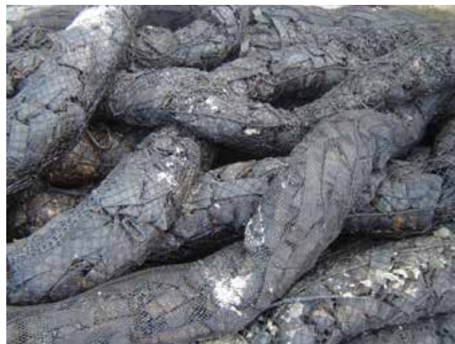
▲ Рис. 3: Ленты полипропилена, заключенные в сетку. Несвязанная негетерогенная структура бона позволяет нефти легко проникать в структуру, обеспечивая адсорбцию нефти внутренними поверхностями, но сетка, в которую помещен сорбент, может быть легко повреждена.
