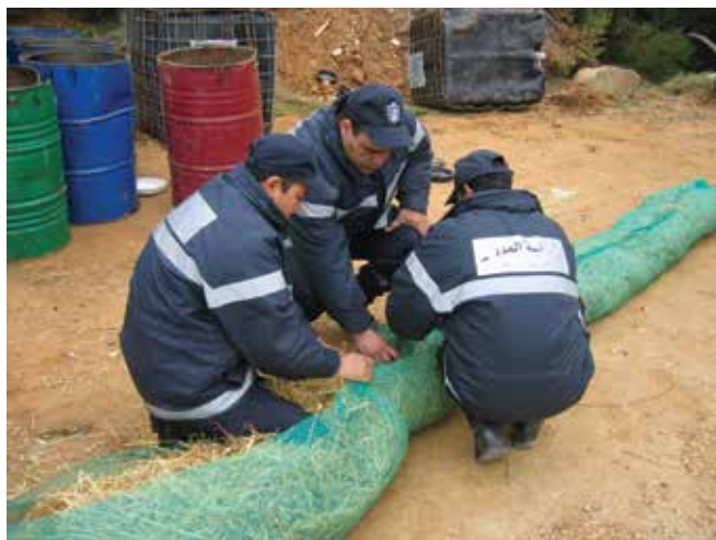
▲ Рис. 2: Импровизированные сорбирующие боны, изготовленные из соломы и сетки. Стоимость таких бонев невелика, они просты в изготовлении и могут обеспечивать эффективную кратковременную защиту при использовании на подходящих участках.
