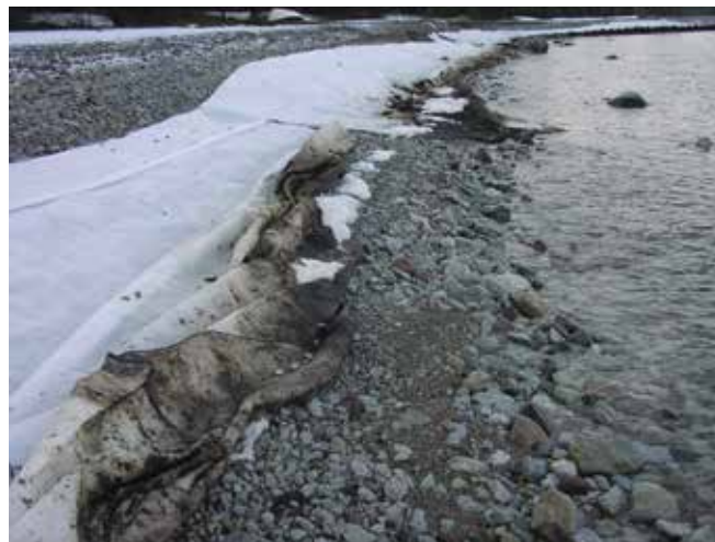
▲ Рис. 5: Сплошные плоские сорбенты, подобные этому листу, разложенному по береговой линии, характеризуются высоким отношением площади поверхности к объему. Крупномасштабное применение сорбента таким образом должно быть сопоставлено с образованием значительного объема потенциально незагрязненных отходов.
