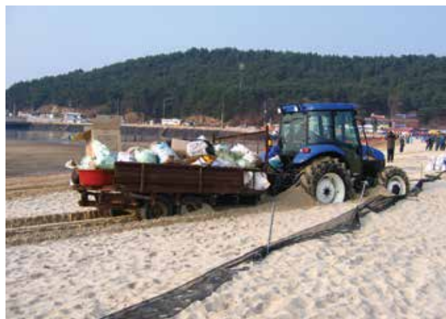
▲ Рис. 39: Загруженные транспортные средства могут оседать в мягких нижних слоях. Это может приводить к дополнительному ущербу и перемешиванию нефти с ранее незагрязненным грунтом.
