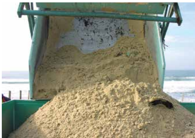
▲ Рис. 7: Сбор отходов тяжелым оборудованием привел к высокому содержанию незагрязненного грунта и к очень низкой концентрации нефти в отходах.
