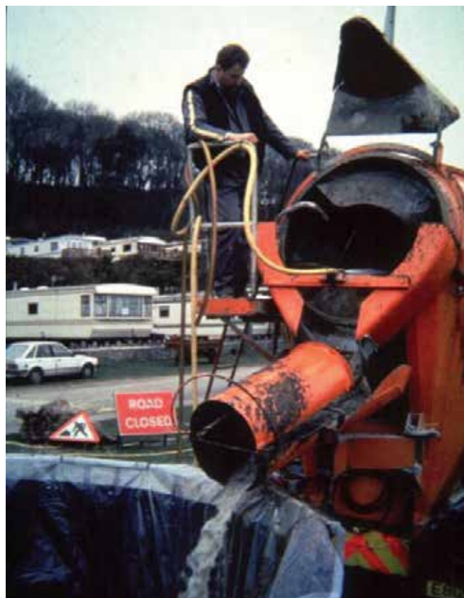
▲ Рис. 24: Выпускная струя из грузовика для перевозки бетонной смеси после промывки гальки и небольших обломков породы.
