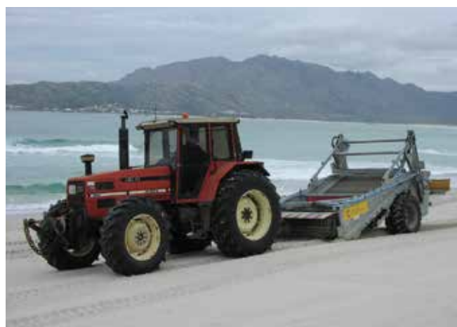
▲ Рис. 26: Машина для сбора смолистых шариков буксируется по пляжу трактором.
