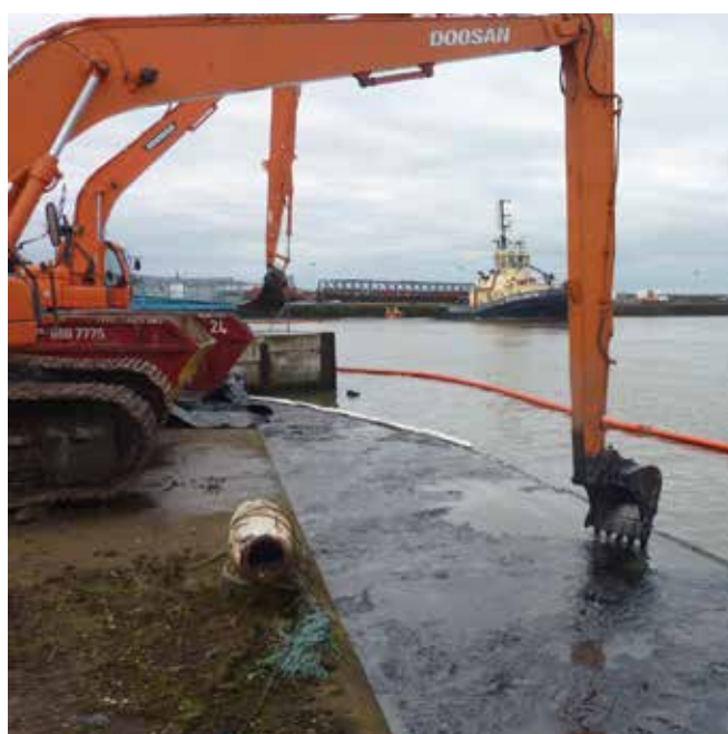
▲ Рис. 5: Строительные машины, применяемые для сбора нефти на территории порта. В данном случае температура воды была ниже температуры застывания нефти, в результате чего нефть приобрела полутвердое состояние, исключаящее применение скиммеров.
