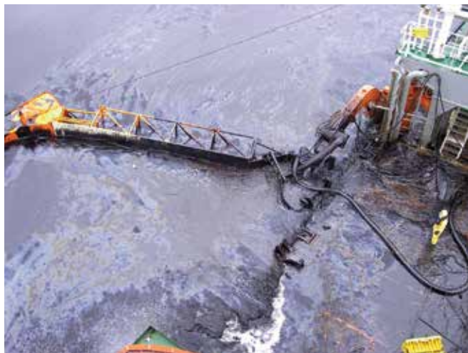
▲ Рис. 33: Жесткая выметающая стрела для сбора нефти, закрепленная с помощью гидравлического крана на судне. Низкий надводный борт и высокий накат волн создали опасные условия на палубе для судовой команды (любезно предоставлено WSA Cuxhaven).
