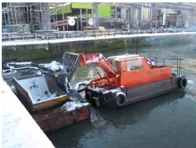
▲ Рис. 35: Самоходное судно, обычно используемое для сбора мусора в порту. В этом случае низкая температура и относительно высокая точка застывания нефти сделали нефть полутвердой, что потребовало сбора черпаками с выгрузкой в плавучий шкип.
