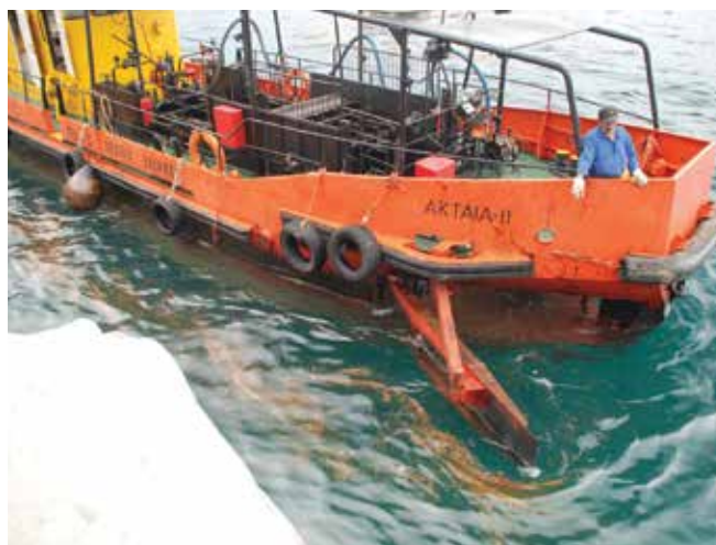
▲ Рис. 1: Самоходный водосливный скиммер, используемый в портах и прибрежных водах. Носовые ворота раскрываются, расширяя полосу захвата и открывая вход для плавающей нефти. Собранная нефть перекачивается во внутренний накопительный бак.
