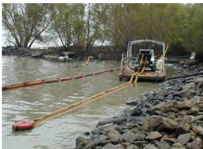
▲ ▶ Рис. 6 и 7: Горизонтальный и вертикальный олеофильные скиммеры с использованием канатов (трос-швабры). Переплетенные сорбирующие петли образуют плавающую швабру, к которой прилипает нефть. Швабра оттягивается назад на барабан, и нефть выжимается в накопительный бак. Скиммеры по типу трос-швабры полезны для сбора нефти среди мусора, льда и других видов засорения.
