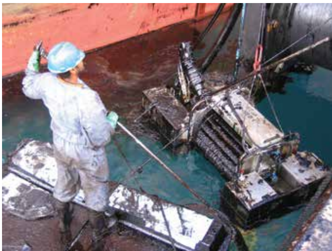
▲ Рис. 17: Механический барабанный скиммер, эксплуатируемый на территории порта. Зубцы на вращающемся барабане привлекают нефть к устройству, где она собирается в барабане и перекачивается в накопительный бак. Барабан изготовлен из сетки для минимального забора воды.
