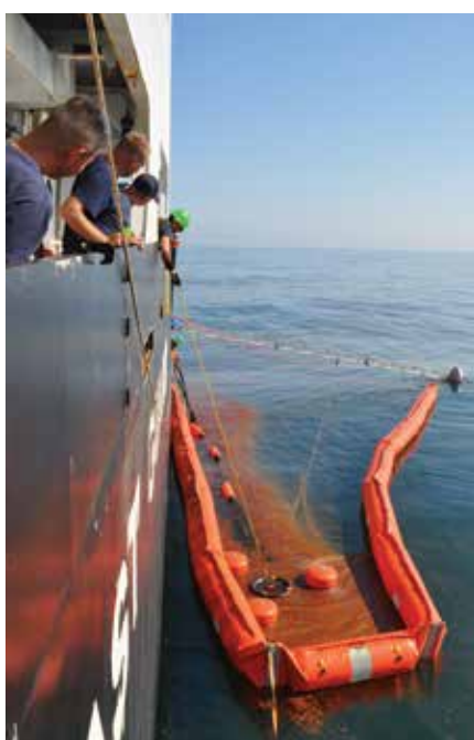
◀ Рис. 31: Система сбора с одним судном, включающая надувной бон, прикрепленный к выносной стреле, и высокопроизводительный свободно плавающий водосливный скиммер, смонтированный на судне береговой охраны. Высокий надводный борт обеспечивает возможность спуска с подветренного борта в более спокойных водах (любезно предоставлено Береговая охрана США).
