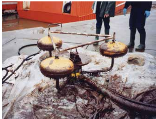
▲ Рис. 37: Водосливный скиммер, доставленный на берег после сбора тяжелой нефти. После использования оборудование подлежит очистке и осмотру для приведения в готовность для последующего использования.
