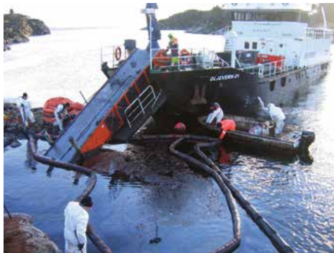
▲ Рис. 15: Ленточный скиммер, установленный на большом судне. Лента, изготовленная из сетки, позволяет отток воды и способствует прилипанию нефти. Нефть поднимается на борт и очищается в накопительный бак.
