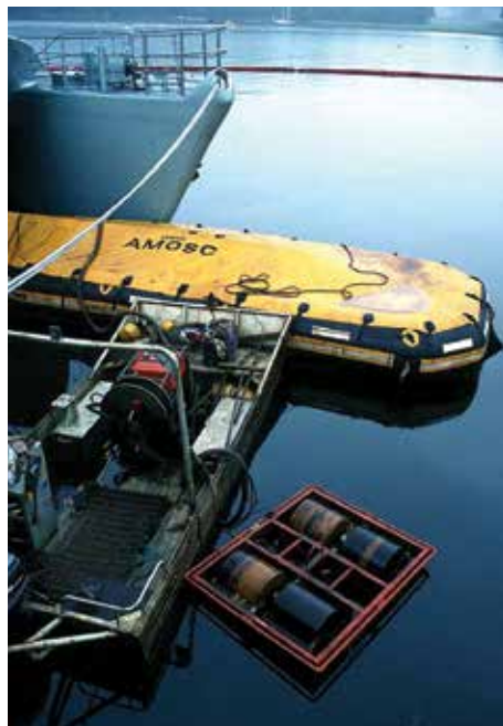
▲ Рис. 26: Барабанный скиммер собирает нефть в надувную баржу-накопитель.
