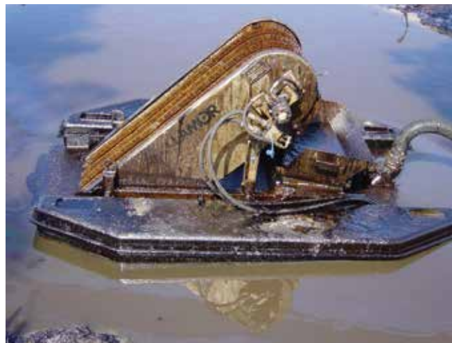
▲ Рис. 5: Свободно плавающий щеточный скиммер. Нефть прилипает к вращающимся щеткам и снимается с поверхности воды. Гребень отводит нефть с щеток в приемный бак. Расположенный позади щетки пропеллер подталкивает плавающую нефть к скиммеру для повышения скорости забора нефти и пропускной способности (любезно предоставлено Lamor).
