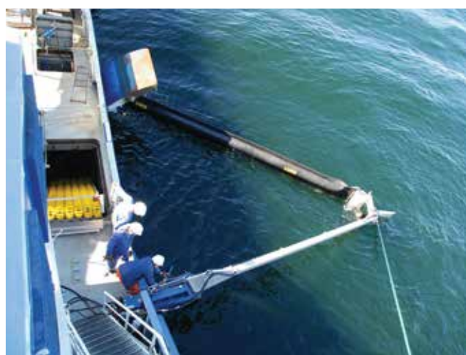
▲ Рис. 32: Встроенная система сбора нефти с одного судна. Бон, размещенный в отсеке по борту судна, разворачивается через отверстие с помощью бортового крана. Это отверстие также помогает собрать увлеченную нефть с помощью бортового скиммера, имеющего в данном примере шесть комплектов щеток в конвейерной схеме (любезно предоставлено Lator).
