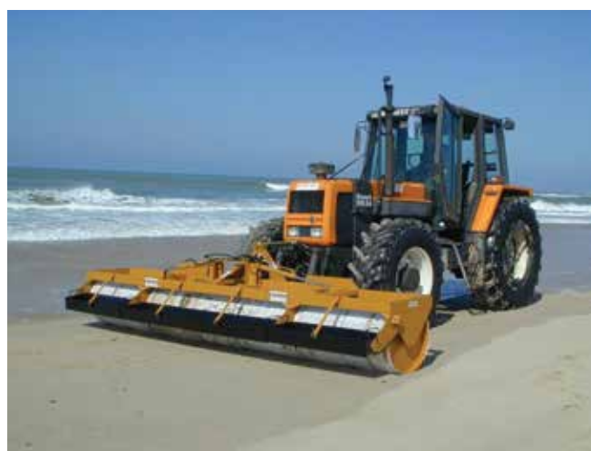
▲ Рис. 36: Смонтированный на тракторе олеофильный барабанный скиммер используется для сбора свежих смолистых шариков на пляже с плотным песчаным покрытием (любезно предоставлено Le Floch Dépollution).
