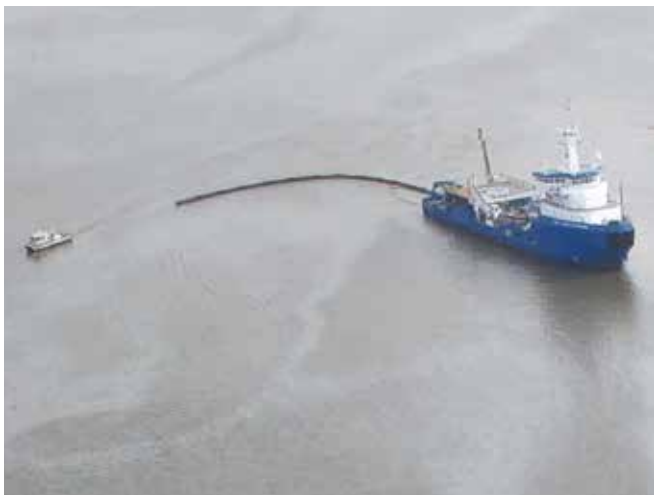
▲ Рис. 29: Бон, буксируемый в U-образной конфигурации, со спущенными с главного нефтесборщика скиммерами.
