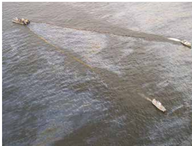
▲ Рис. 30: Судно с ленточным скиммером, спущенным с бонном, и буксировочные суда в V-образной конфигурации.
