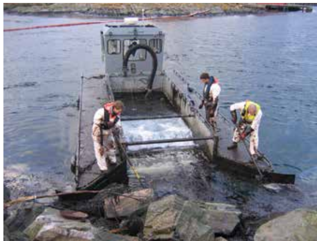
▲ Рис. 34: Самоходный водосливный скиммер собирает нефть в укрытой скалистой бухте. Малая осадка судна позволяет работать близко к берегу. Операторы помогают, подгоняя нефть в выпуск водослива.
