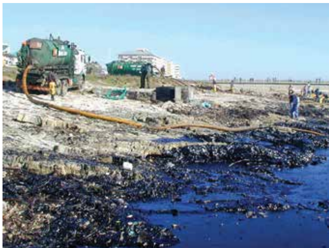
▲ Рис. 8: Благодаря широкой доступности вакуумных систем эти устройства идеально подходят для сбора нефти в прибрежной зоне и на берегу.
