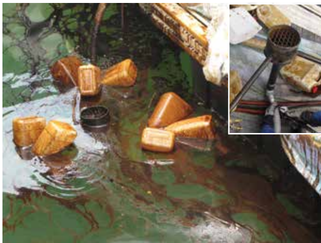
▲ Рис. 14: Импровизированный водосливный скиммер, построенный из пластиковых бутылок и металлических обрезков, прикрепленный к вакуумному насосу. Это устройство обеспечивает первичный сбор нефти и может регулироваться путем снятия или добавления бутылок.
