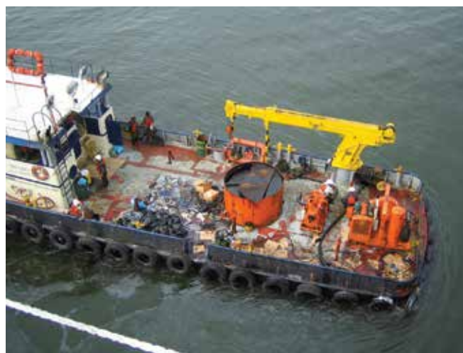
▲ Рис. 24: Рабочее судно с ограниченной емкостью для хранения нефти на палубе.
