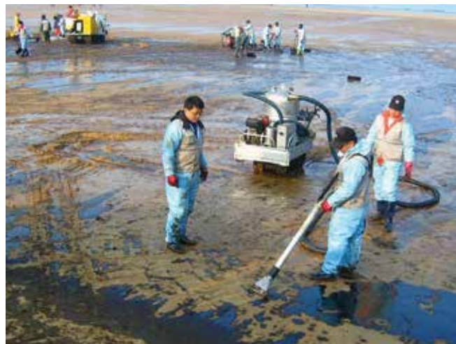
▲ Рис. 9: Мобильные вакуумные системы могут облегчить сбор нефти на песчаных пляжах и скалистых береговых линиях. Компактная система позволяет работать на труднодоступных участках, хотя возможности накопления собранной нефти ограничены.
