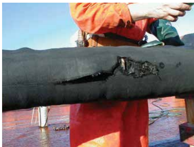
▲ Рис. 23: Разрыв рукава, вызванный чрезмерным внутренним давлением от прокачки высоковязкой нефти (любезно предоставлено NOFO).
