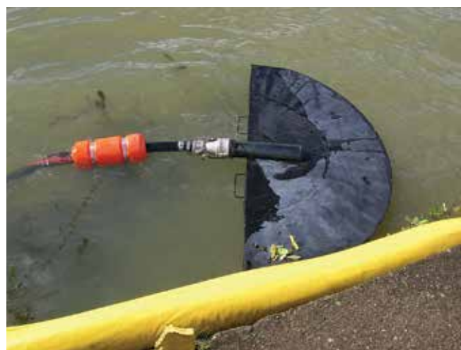
▲ Рис. 11: Фиксированный водосливный скиммер, прикрепленный к вакуумному насосу. Ряд небольших впусков по краю головки обеспечивает избирательный сбор нефти. Для применения в спокойной воде с минимальным количеством мусора (любезно предоставлено Lator).
