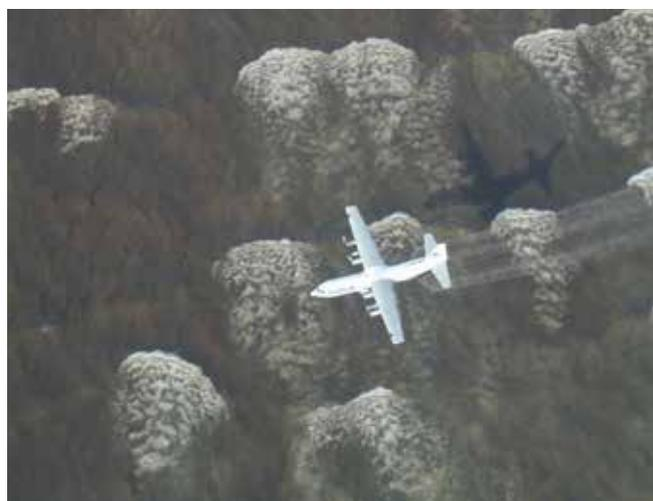
▲ Рис. 10: Нанесение диспергента с многомоторного самолета. В этом случае нанесение диспергента на мелководье было сочтено целесообразным.
