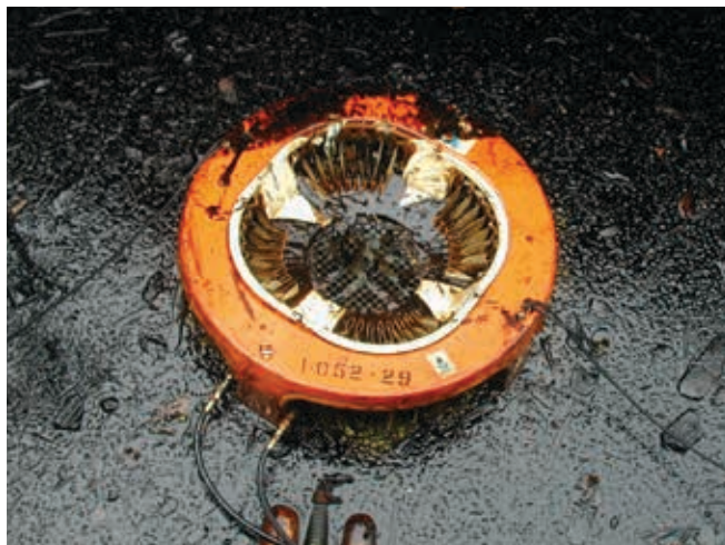
▲ Рис. 15: Дисковый скиммер, успешно функционирующий в свежеразлитой нефти легкой фракции. В случае значительного эмульгирования нефти эффективность операции по ее устранению снизилась бы по причине неспособности эмульсии прилипнуть к дискам.
