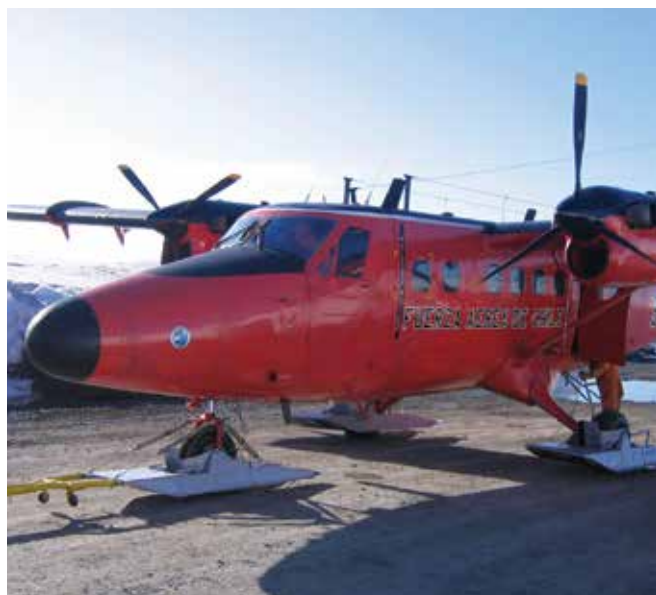
▲ Рис. 2: Идеальными платформами для воздушного наблюдения нефти на поверхности акватории являются двухмоторные самолеты с высоко расположенным неподвижным крылом. Вертолеты могут быть предпочтительнее для проведения наблюдений вблизи побережья благодаря более высокой маневренности и более низкой скорости.
