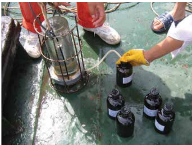
▲ Рис. 8: Сцеживание проб воды из пробоотборника в стеклянные бутылки в целях получения разделенных проб.
