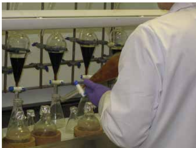
▲ Рис. 13: Экстрагирование проб нефти с помощью делительной воронки (любезно предоставлено CEFAS).
