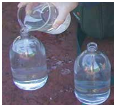
▲ Рис. 12: Узкогорлые бутылки прозрачного стекла (слева) или бутылки из полимерных материалов (справа) желательно не применять в целях мониторинга.
