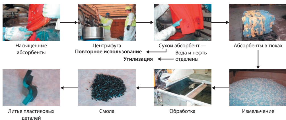
Рисунок 7 Демонстрация процесса переработки материала из боновых заграждений в пластиковые изделия
