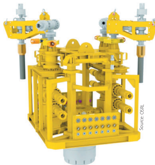
Рисунок 7 Пример аварийной заглушки для подводных скважин
