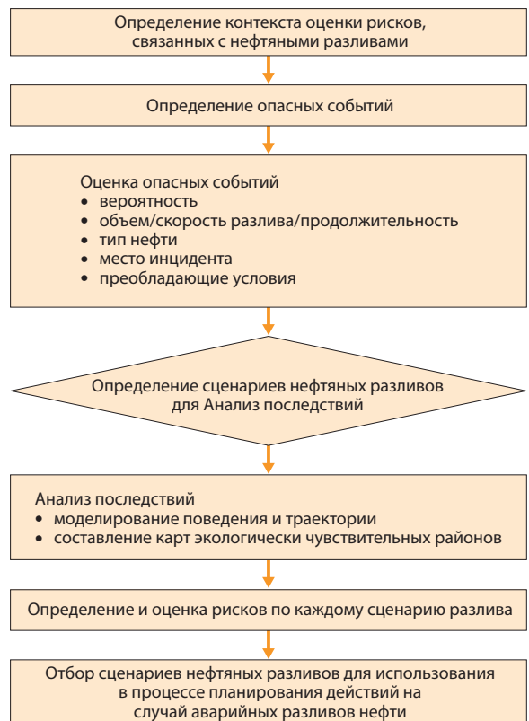
Рисунок 2 Обобщенный процесс разработки сценария нефтяного разлива
